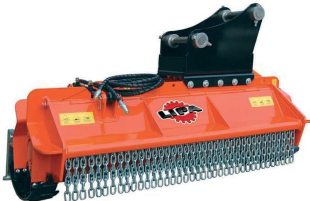
La Testata trinciante forestale TLE-FL con mazza a scomparsa unidirezionale è ideale nella trinciatura di erba, canne e arbusti fino ad un max di 15cm di diametro in prossimità di fossati, argini e terreni in forte pendenza o anche in aree incolte e boschive. La testata trinciante TLE-FL è applicabile a escavatori con peso da 12T a 18T.
