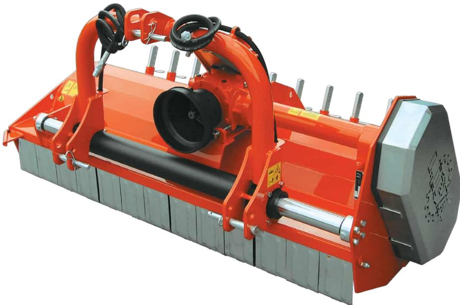
Il Trinciatutto TLSP è un'attrezzatura utilizzata per la trinciatura di erba e sarmenti, di potatura di vigneti, frutteti e uliveti. Dispone di attacco a tre punti ed è applicabile a trattori cingolate e gommate. Il trinciatutto TLSP si caratterizza per lo spostamento idraulico (max 40 cm) che ne consente l'impiego in posizione decentrata per lavori di accostamento alle colture.
