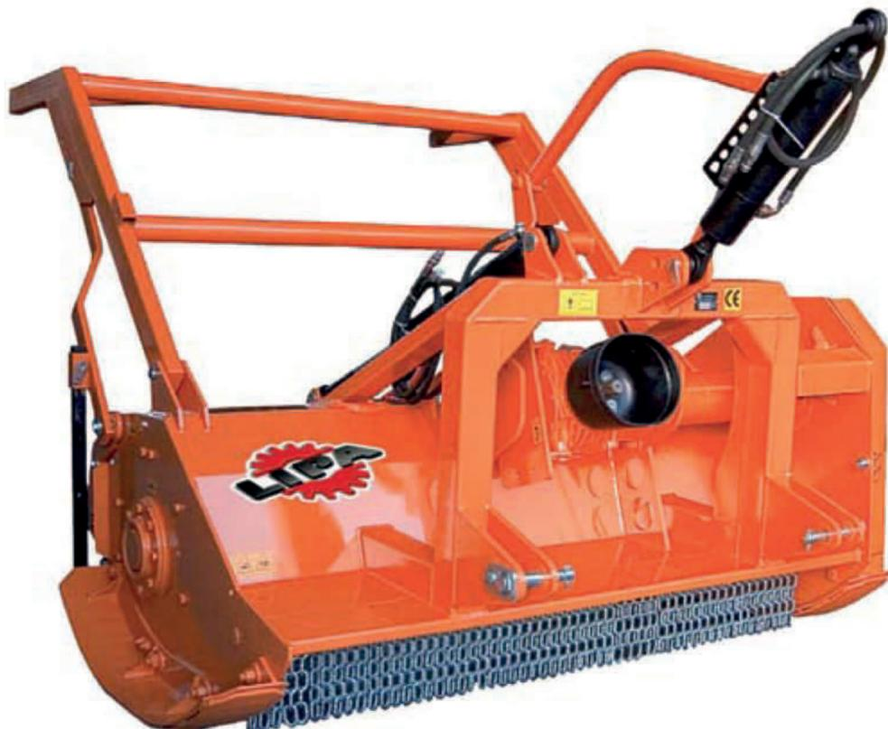
Il Trinciatutto UFM è un'attrezzatura ideale in selvicoltura per lavorazioni di sfollamento di retro sentieri nelle boscaglie, sfollamento di sentieri spartifuoco, trinciatura di residui forestali e di legname. in agricoltura per lavorazioni di dissodamento di frutteti, trinciature di ramaglie, impiego con montaggio posteriore e frontale.
