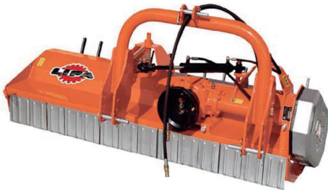
Il Trinciattutto TLS è un'attrezzatura utilizzata per la trinciatura di erba e sarmenti, di potatura di vigneti, frutteti e uliveti. Dispone di attacco a tre punti ed è applicabile a trattrici cingolate e gommate. Il trinciattutto TLS si caratterizza per lo spostamento idraulico trasversale (max 40 cm) che ne consente l'impiego in posizione decentrata per lavori di accostamento alle colture.
