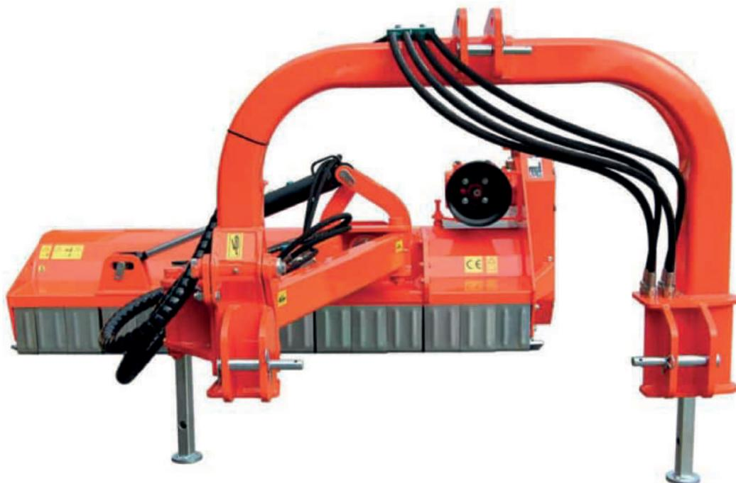
Il Trinciatutto TLA è un'attrezzatura ideale per la triturazione di arbusti in prossimità di fossati, argini, vigneti e frutteti. Il braccio a disposizione permette una varietà di utilizzo dell'attrezzatura: internamente come una comune trincia, lateralmente per lavori in prossimità di fine campo o fossi e in posizione verticale per potature di siepi.
