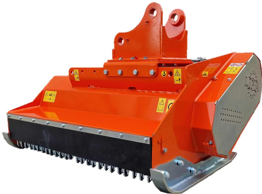
La Testata trinciante TLBE-S è ideale nella trinciatura dell'erba, canne e arbusti fino ad un massimo di 7/8 cm di diametro, in prossimità di fossati, argini ed in tutti i terreni a forte pendenza. Si adatta a escavatori con peso a partire da 5 t.
