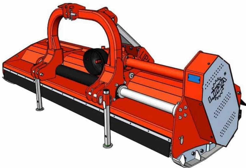
Il Trinciatutto SHU-S è un'attrezzatura ideale per lavorazioni in selvicoltura e nei pascoli. Dispone di attacco a tre punti ed è applicabile a trattori cingolate e gommate. Lo spostamento idraulico (max 45 cm) consente l'impiego del trinciatutto in posizione decentrata per lavori di accostamento alle colture.
