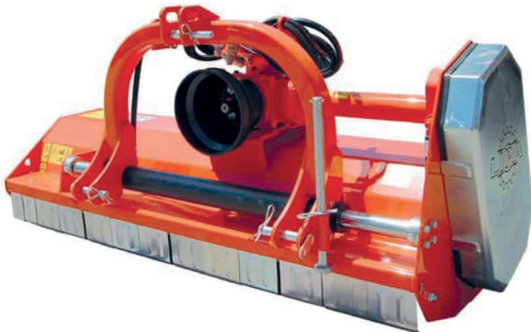
Il Trinciattutto TLBS è un'attrezzatura utilizzata per la trinciatura di erbe e sarmenti di piccole dimensioni. Dispone di attacco a tre punti ed è applicabile a trattori cingolati e gommati. Lo spostamento idraulico (max 30 cm) permette l'impiego in posizione decentrata per lavorazioni di accostamento alle colture, piantagioni, frutteti ecc.
