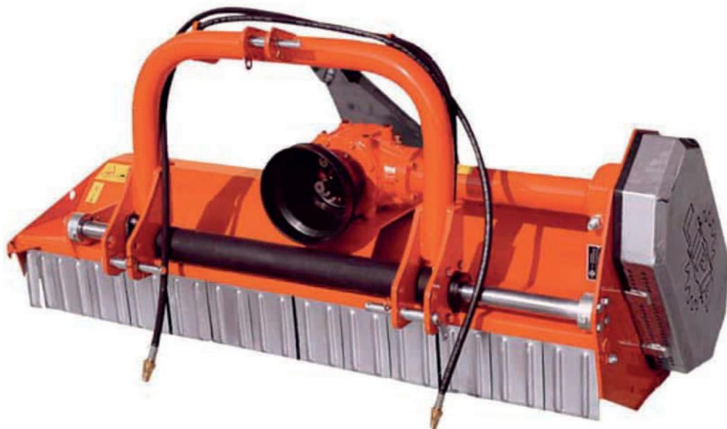
Il Trinciatutto TLGS è un'attrezzatura utilizzata per la triturazione di erbe e sarmenti di vigneti e frutteti. Dispone di attacco a tre punti ed è applicabile a trattori cingolate e gommate. Lo spostamento idraulico (max 40 cm) permette l'impiego in posizione decentrata in modo da consentire lavorazioni più vicine alle piantagioni, frutteti, ecc.
