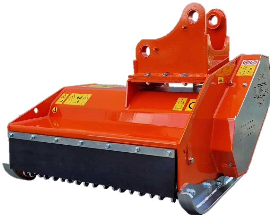
La Testata trinciante TLBE è ideale nella triturazione dell'erba, canne e arbusti fino ad un massimo di 5 cm di diametro in prossimità di fossati, argini ed in tutti i terreni a forte pendenza. Si adatta a mini escavatori con peso da 1,8 t a 5 t.
