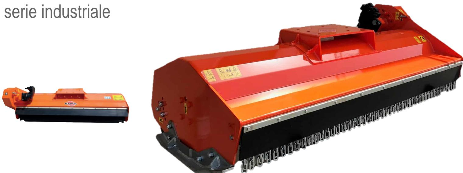
La Testata trinciante idraulica TLF-E è un'attrezzatura adatta alla triturazione, taglio di erba ed arbusti in genere fino ad un massimo di 7/8 cm di diametro. È ideale per la pulizia ed il mantenimento di argini, canali, fossati ed ampi spazi. Si adatta a escavatori con peso da 10T a 16T.
